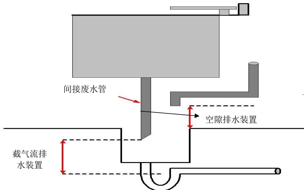
在上图中，水槽下方的间接废水管终止于带有**截气流装置**(图左方-未获批准用于食物处理)的废物接收器。而(图右方的另一个水槽)所连接的第二条管道终止于带有**空隙装置**(食物处理的必要条件)的废物接收器。图中的废物接收器是一个落地水槽。空隙的高度应至少是废水管直径的两倍，且不得小于一英寸。
